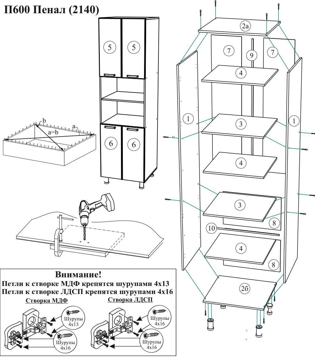
После сборки рекомендуем выставить по месту пенал, отрегулировать высоту с помощью опор, скрепить его межсекционной стяжкой с соседними модулями (отверстие под стяжку сверлится **самостоятельно** сверлом Ø 5-6мм), навесить фасады.
