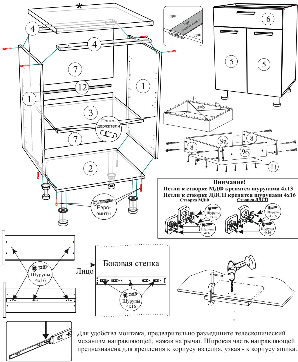
После сборки рекомендуем выставить по месту все столы, отрегулировать высоту с помощью опор, скрепить их межсекционной стяжкой (отверстие под стяжку сверлится самостоятельно сверлом Ø 5-6мм), затем закрепить столешницу отступив вперед от боковой стенки **50мм**, навесить фасады.
