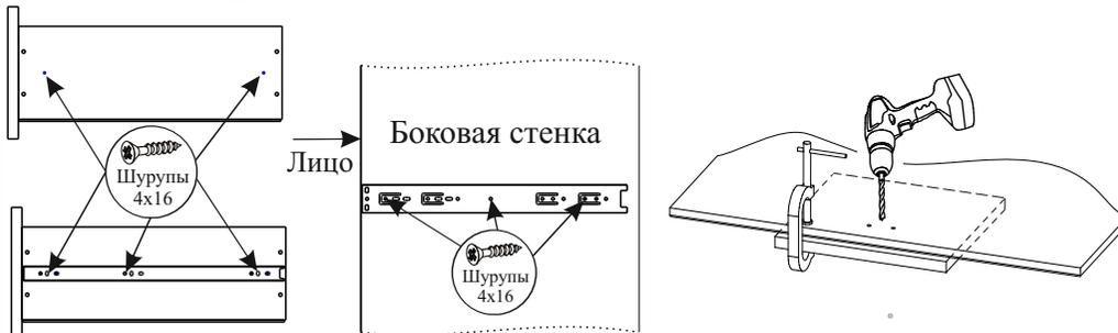
Для удобства монтажа, предварительно разъедините телескопический механизм направляющей, нажав на рычаг. Широкая часть направляющей предназначена для крепления к корпусу изделия, узкая - к корпусу ящика.
